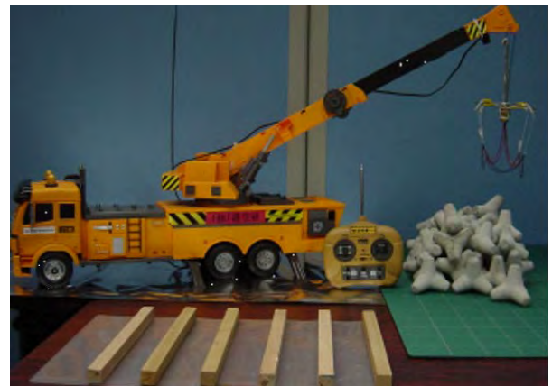
写真-4.6 4脚ブロック模型実験
