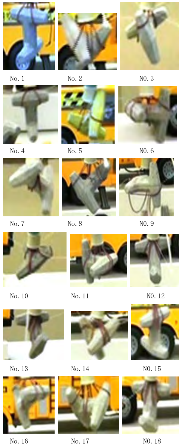
写真-4.4 錨型ブロック模型の吊り上げ状態
