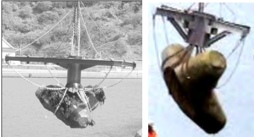
破損4脚ブロック
