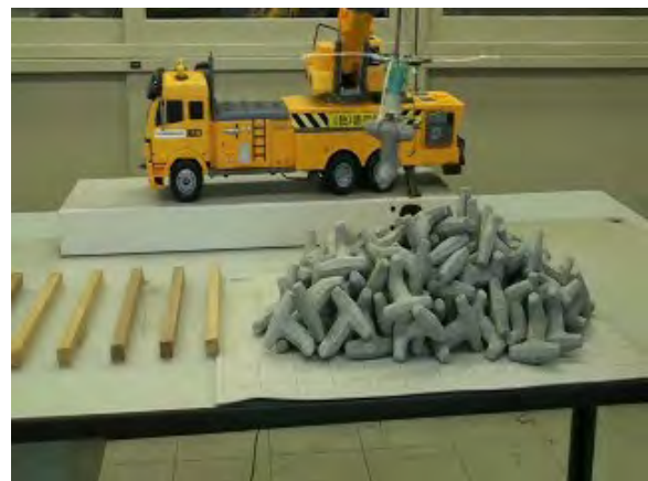
写真-4.1 ブロック把持模型実験装置
