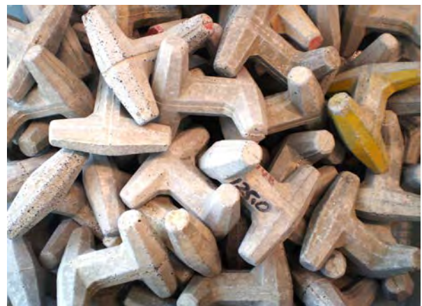
写真-3.1 錨型ブロック乱積み状態(上方より)
