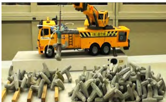
写真-4.3 18個目のブロック吊り上げ
