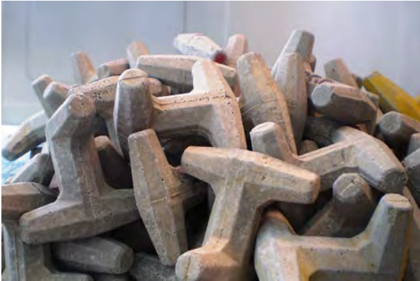
写真-3.2 錨型ブロック乱積み状態（側方より）
