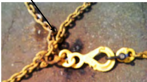
写真-1.3 フックを挿入した網チェーン
