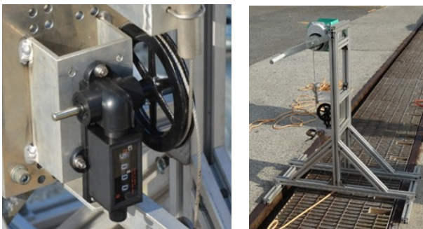
図-7.5 ワイヤーロープ繰り出し量表示とウィンチ全景
