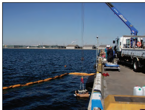
写真-3.4 ROVの海上への吊降ろし
