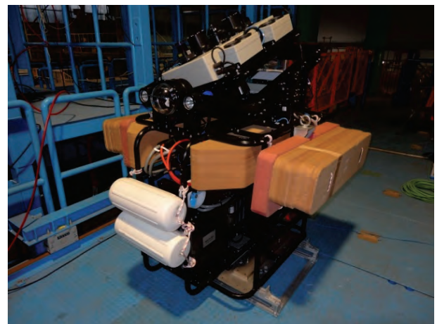
写真-4.8 試験機への自動雲台の搭載状況(約230kg)
