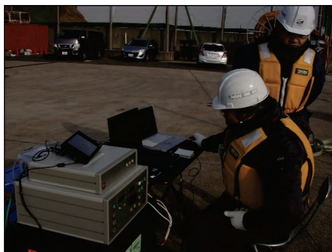
写真-3.6 ROVの陸上制御機器
