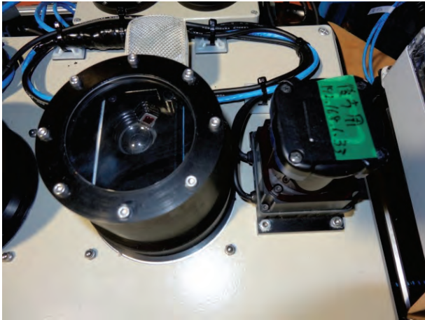
写真-2.8 上方距離計SICK社DT500-A112
