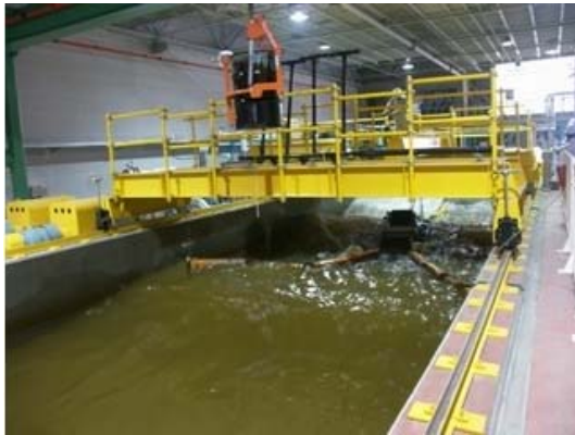
図- 3.4: 油回収機性能試験の様子
