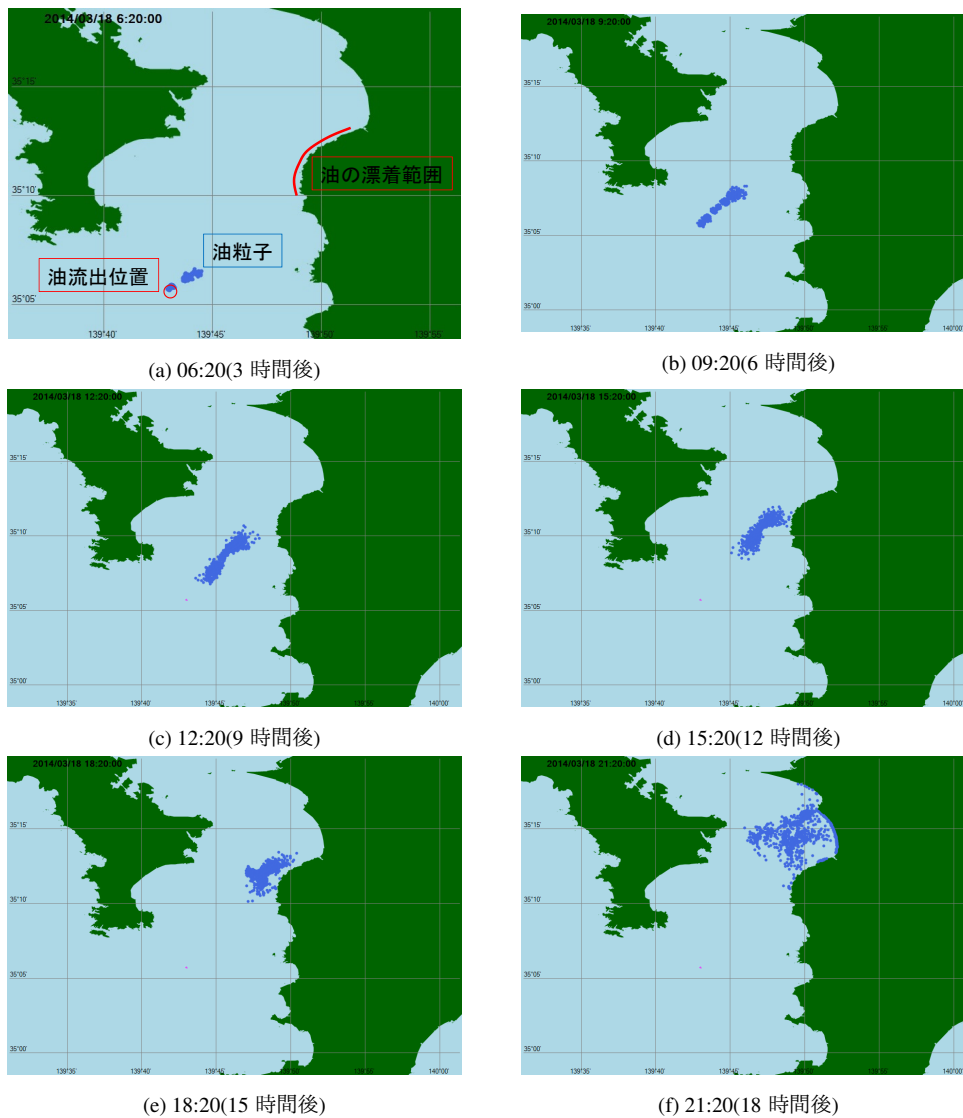
図- 7.7: 流出油の漂流予測計算結果
