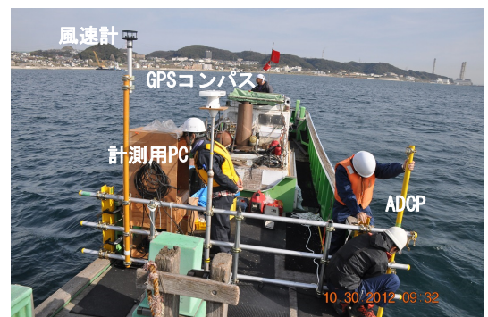
図- 4.10: 風況及び流況データ計測方法
