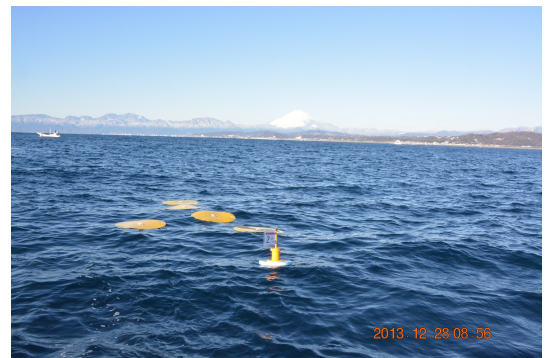
図- 4.9: 疑似油漂流実験状況（平塚市周辺）
