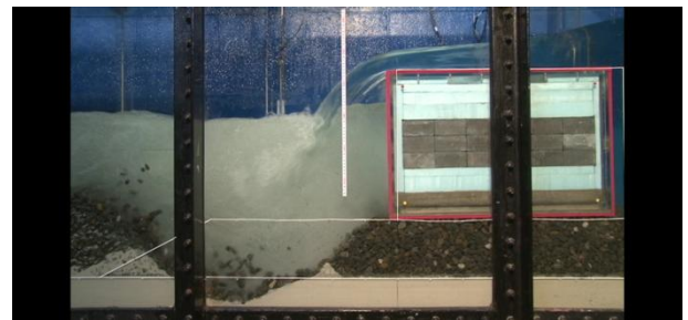
K-N-1_2ケーソン倒壊直前(実験開始355sec経過後)
