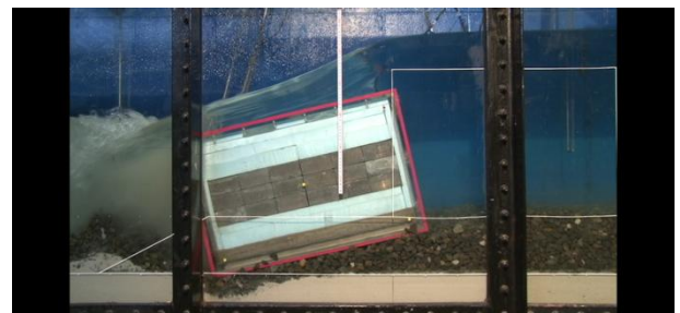
K-N-1_2ケーソン倒壊直後(実験開始370sec経過後)
