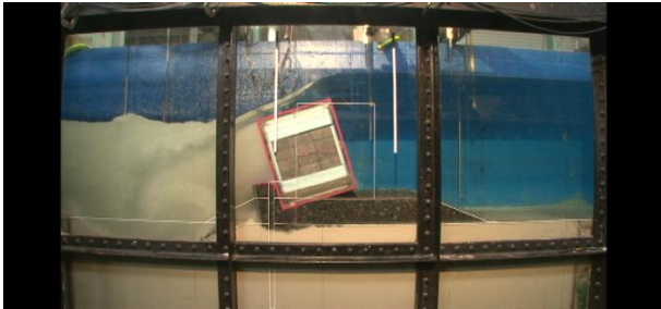
O-P-1_1'杭傾斜度30%(堰上後125sec経過後)
