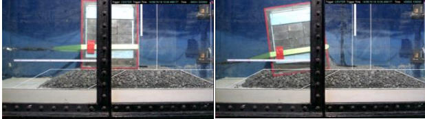
気中マウンド(左:倒壊直前, 右:倒壊直後)
