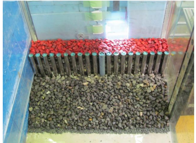
写真-2.1 港内側の設置状況(杭方式)
