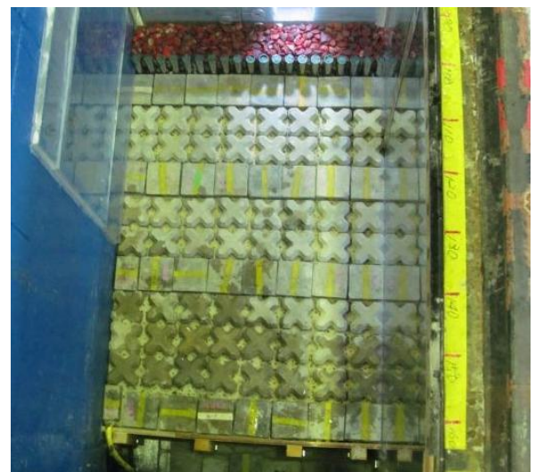
写真-2.10 港内側洗掘防止の状況(O-PB)
