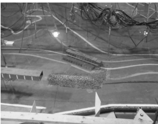
(b) 越波抑制案 (2) : 沖潜堤
