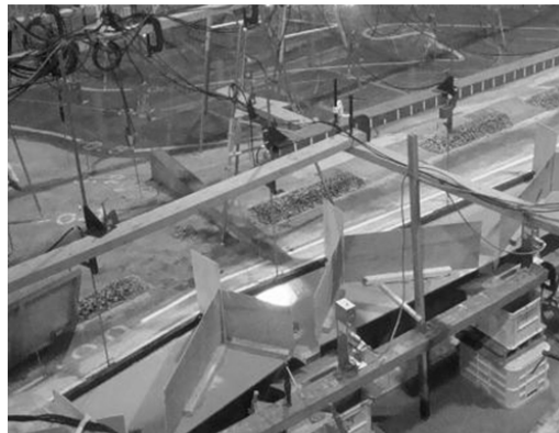
(a) 越波抑制案 (1) : 突堤
