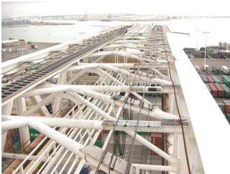
写真-2.7 ブームの構造 (KOCKS 社製クレーン, X424)
