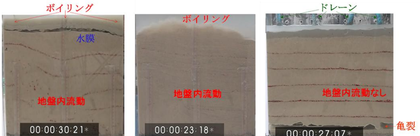
図-3.5 地盤内流動・ボイリングの発生状況：(a) ケース 1, 図-3a (b) ケース 6, 図-3f (c) ケース 4, 図-3d に対応
