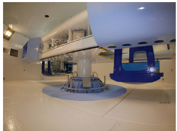
図-2.6 遠心模型実験装置 PARI Mark II-R 13)
