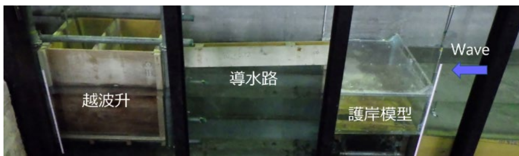
写真-2.3 護岸模型と導水路、越波升の設置状況
