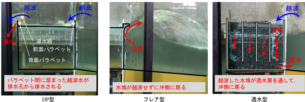
図-3.43 改良型護岸の越波状況
