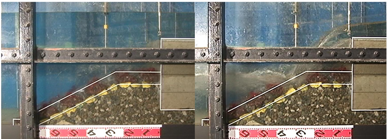
図-4.3 法肩部模型の移動前後の状況（網袋式被覆工、重積み 越流水深:14cm 港内堰高:17cm）
