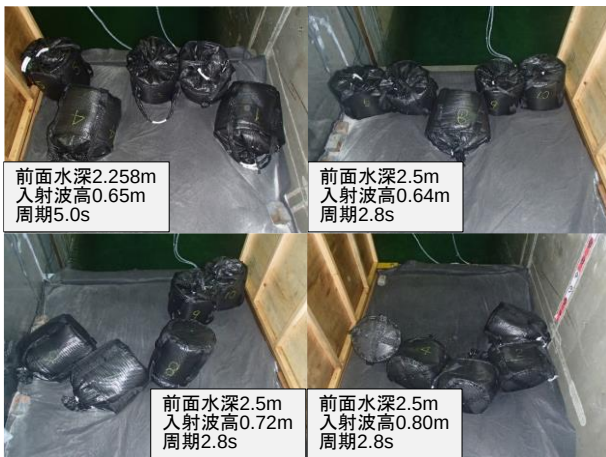
図-5.4 造波後の土のう模型の被災状況の例
