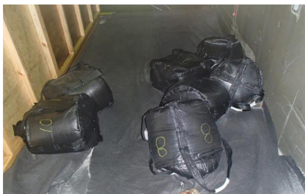
図-5.18 連結していない場合の波作用後の状況
