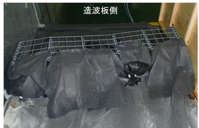
図-5.14 連結した土のう模型の造波後の様子
