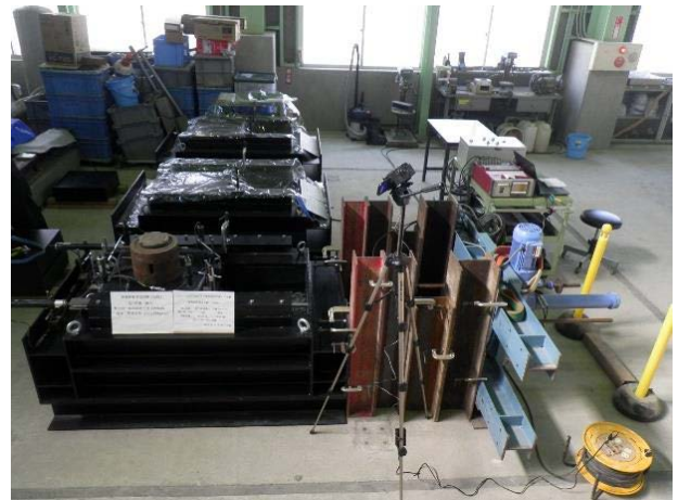
写真-5.6 せん断載荷実験の状況 (GF-1 の例)
