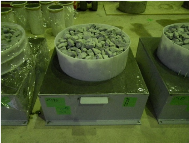
写真-4.2 礫材の設置状況
