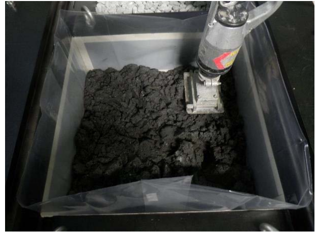
b) カルシア改質土の投入および転圧
