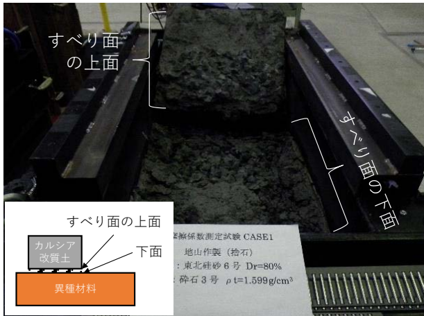
a) 载荷後、上部のカルシア改質土を反転させた様子
