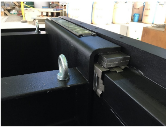
e) フラットローラーの設置状況
