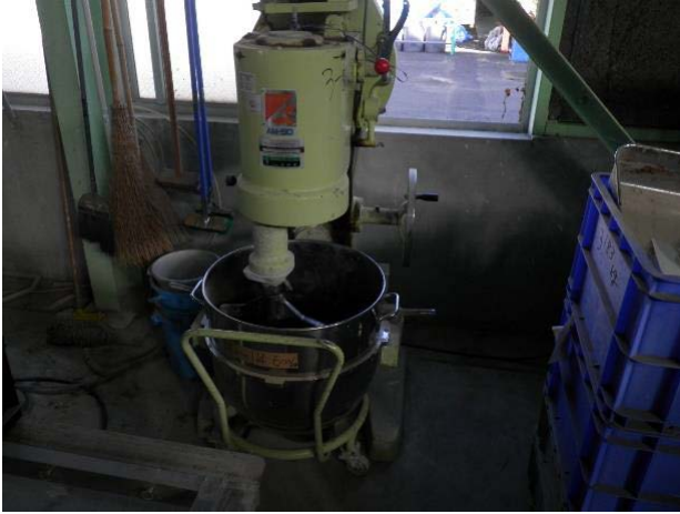
a) 攪拌状況 (使用したミキサー: 愛工舎製作所 AM-90)
