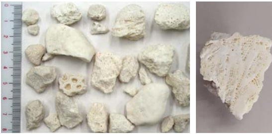
写真-1 珊瑚粗骨材の外観
