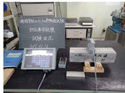
写真-5 熱伝導率の測定状況
