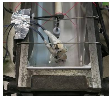
写真-4 粗骨材の設置状況
