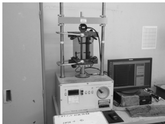
図-B.1 模型材料の引張試験状況
