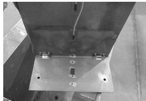
図-4.2 試料容器底版と模型矢板の構造
