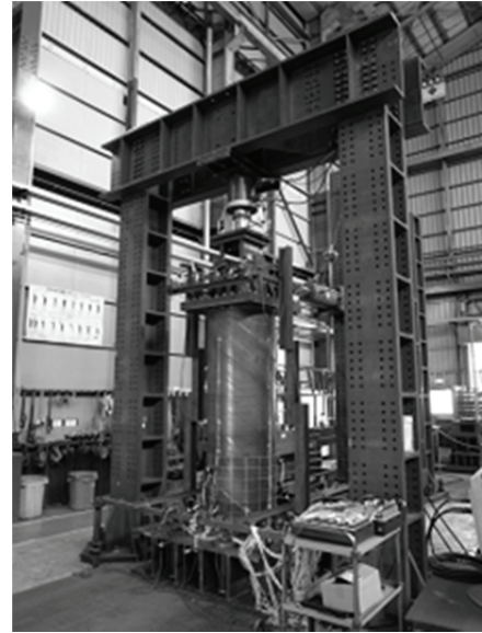
写真-3.1 スパイラル鋼管の正負交番実験
