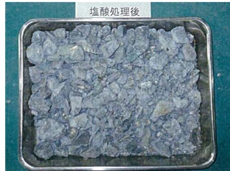
写真-6.6 塩酸処理後の残渣物の乾燥後の状態
