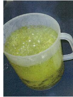
写真-6.5 粉碎した試料の希塩酸による溶解
