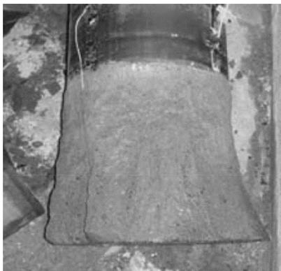
図-3.8 ケースK1解体時の杭先端部の様子
