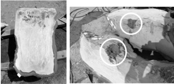
図-3.28 case2の先端根固め部の外観と内部の状況（丸固め部に土塊が混入）
