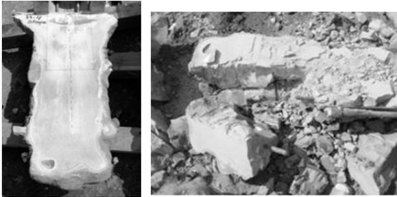
図-3.29 case4の先端根固め部の内部の状況
