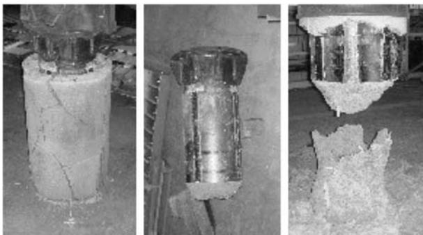
図-3.7 実験後の模型の様子. 左からケース1 (加圧容器から取出し後), ケース1の解体後 (杭体と杭直下部分のモルタル), ケース2の解体後 (杭先端部と模型底部のモルタル).
