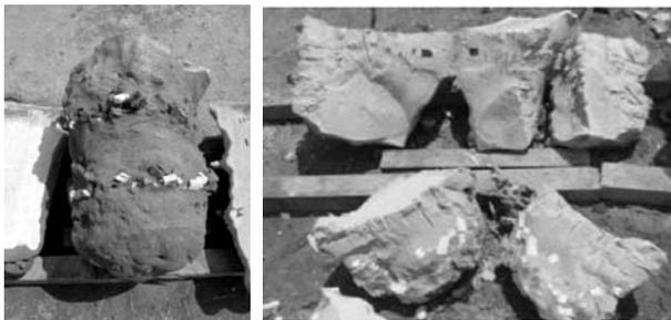
図-3.25 case11の先端根固め部の外観と内部の状況
