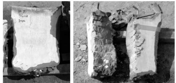
図-3.33 case7の先端根固め部外観と内部の状況
