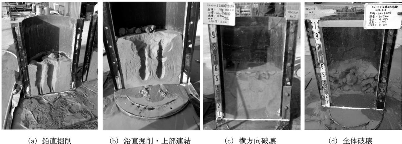
図-3.18 簡易実験で観察された代表的な地盤掘削・破壊状況
