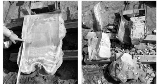
図-3.32 case1の先端根固め部外観と内部の状況
