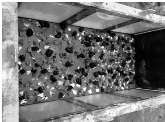
図-3.21 土塊模擬材料の配置状況
