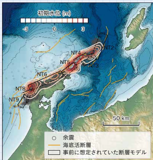
アジョイント合成法による2024年能登半島地震津波の初期水位分布の推定結果
