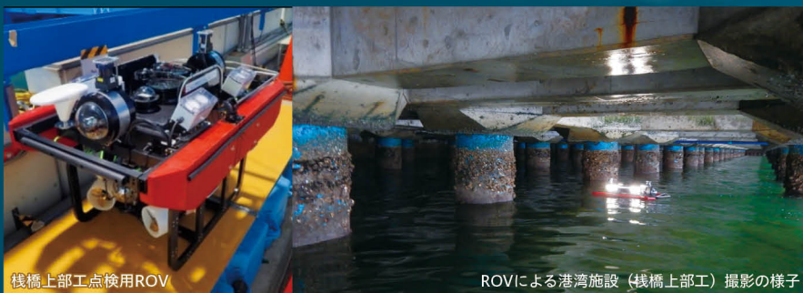
栈橋上部工点検用ROV
