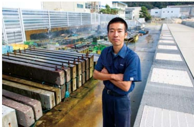
50年から100年と、非常に長い期間の安全性を確保しなければならない港湾構造物。その鍵になるのが、使用する材料や採用する防食工法の長期耐久性の評価です。港湾空港技術研究所では、敷地内にある長期暴露試験場「海水循環水槽」「海水シャワー暴露試験場」と、茨城県神栖市の「波崎海洋研究施設碎波帯観測用桟橋」（以下、波崎観測桟橋）で、長い年月をかけて劣化の進展や耐久性の調査を実施しています。
