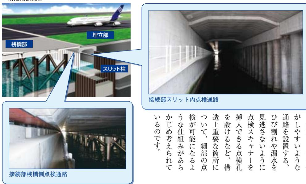
「羽田空港D滑走路の構造」「D滑走路桟橋部」「D滑走路接続部」「接続部桟橋側点検通路」「接続部スリット内点検通路」の図・写真は、東京空港整備事務所 提供
