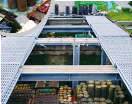
海水シャワー暴露試験場（海水散布時）
