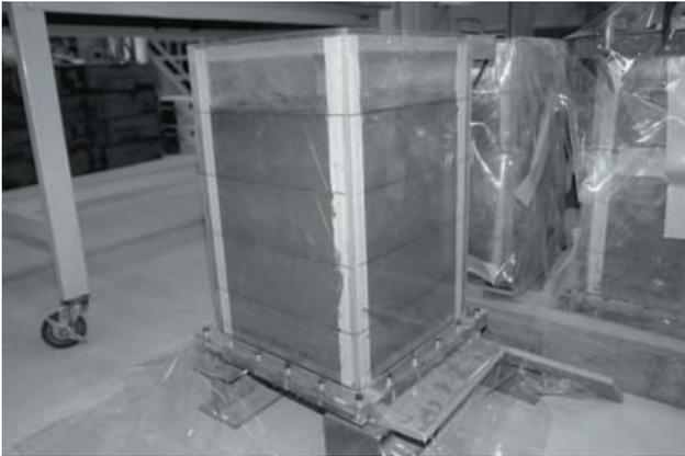
写真-4.1 養生中の模型地盤
