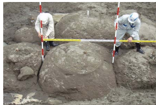
写真-1 改良体の出来形例 (石狩湾新港での現場実験)
