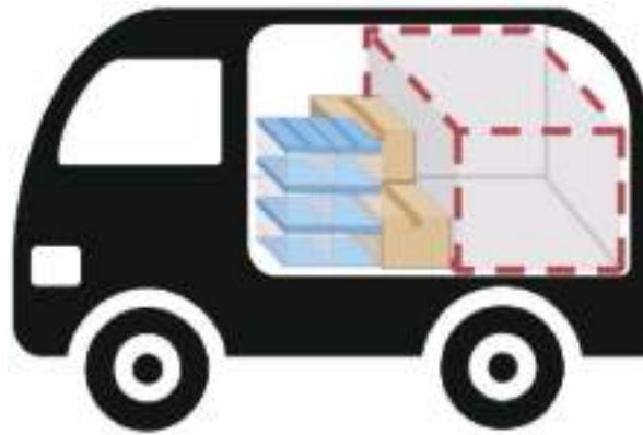
● 図4 深度センサによる空きスペース把握概念図
