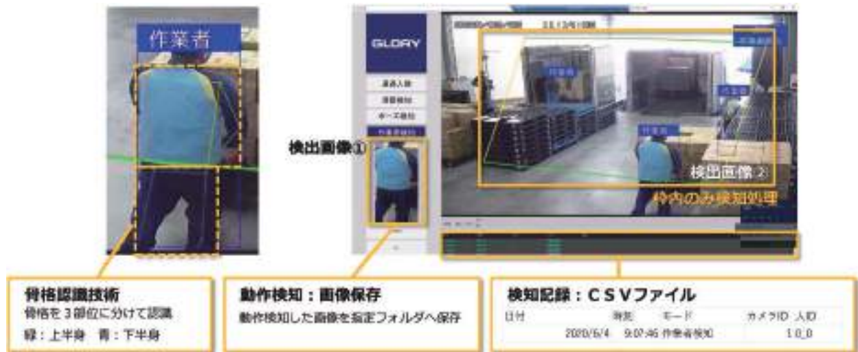
●図6 バース内での作業者の骨格を画像認識した例
