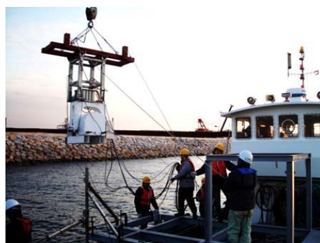
写真-2.1.1.9 東京国際空港(羽田空港)D滑走路建設現場における水中音響映像装置実海域試験と取得画像(平成 22 年 2 月 21 日)
