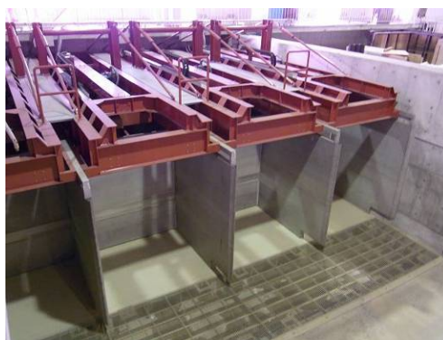
写真-4.1.1.5 水理模型実験水槽の造波装置と潮流吐出口(床面部)
