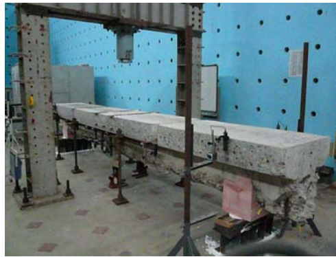
写真-2.1.1.19 劣化した港湾構造物から切り出した部材の載荷実験 (供用後 40 年を経た棧橋上部工部材)
