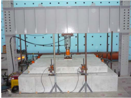
部材接合部の模型載荷実験
