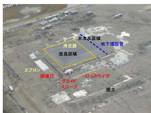
写真-2.1.1.2 石狩湾新港における実物大空港施設の液状化実験の状況（北海道開発局撮影）
