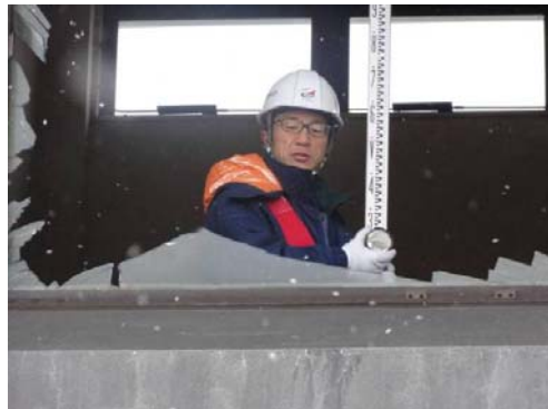
写真-2.2.8.2 仙台塩釜港における津波痕跡高の計測（平成 23 年 3 月 17 日）
