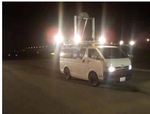
写真-2.1.1.16 赤外線を用いた舗装損傷部の検出実験（福岡空港）
