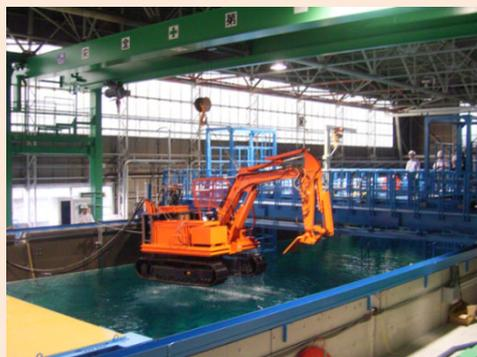
・波浪や構造物を設定できる大型水槽で、実物大の作業機械による水中施工環境を再現可能
