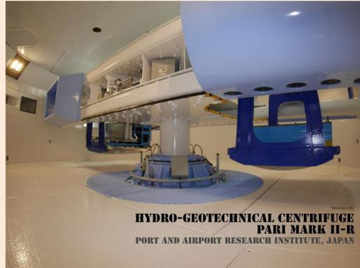
・地盤模型に遠心力を加え実物スケールでの動きを再現でき、地震や波浪、津波の実験も可能
