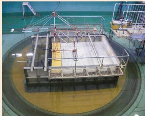
・水中で作動する振動台で、三次元方向に加振して地震力を作用させることが可能
