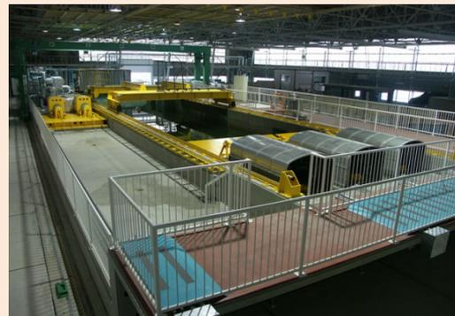
・潮流、波浪、海水温、風などを設定できる大型水槽で海上での油流出状況を再現可能
