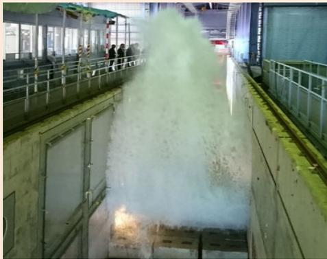
・最大 3.5m の風波と最大 2.5m の津波を起こすことができる世界最大級の造波水路
