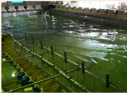
・様々な沖波を広い平面水槽内に造波し、沿岸の海底地形や防波堤による波の変形を再現可能
