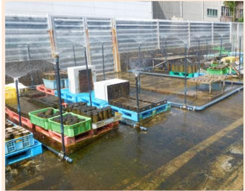
・自然海水を散水し飛沫環境を模擬するとともに、ポンプで給排水し干満環境を模擬した施設
