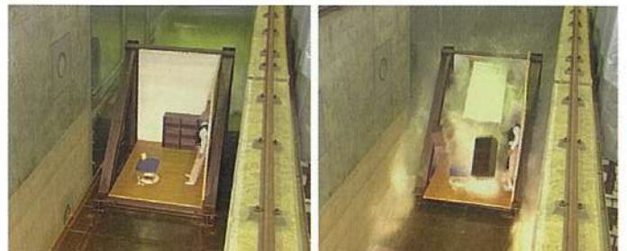
津波が実寸大の家屋模型の壁を破壊した瞬間
