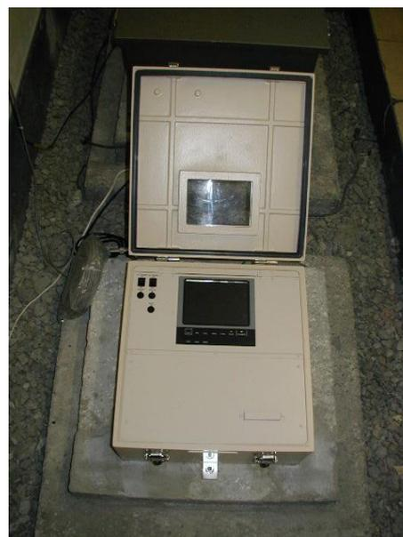
図-16 SMAC-MDU 型強震計の外観
