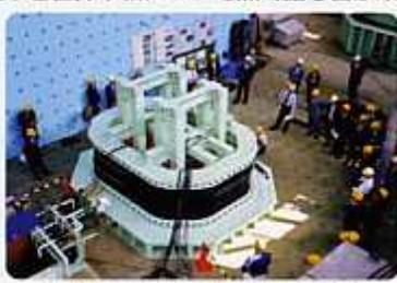
沈埋トンネル用継手の実験状況
