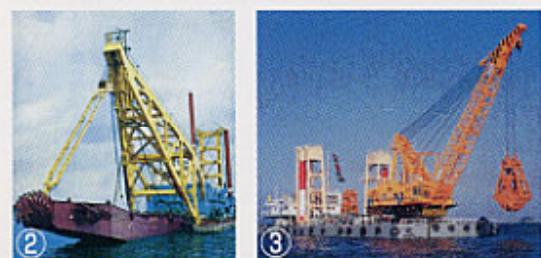
②ポンプ浚渫船：土砂の吸い込み口の先に付けられたカッター等を回転させて土砂を切り崩しながら浚渫します。固めの土砂に用いられます。作業は、船体後部を固定し、土砂吸い込み口のある船体前部を扁型に振りながら行います。
