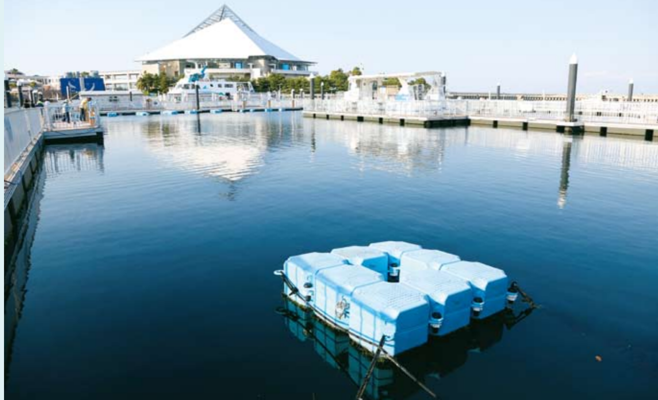
「うみファーム」の施設内。手前に浮いているのがブルーカーボンフロート。フロートの下には海中の生物を付着させる網が下がっている
