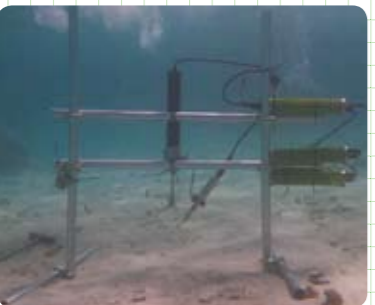
水中渦相関法 水中の堆積物内の光合成・呼吸量を測定
