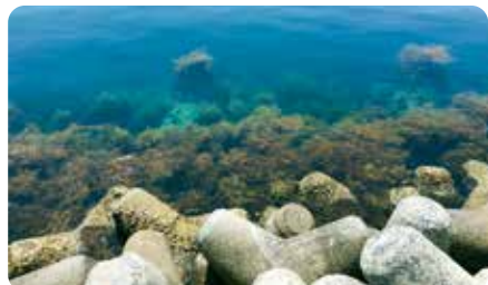
4種類のブロック（鉄鋼スラグ水和硬化体、生コンクリート、クリンカコンクリート、石炭灰重量モルタル）を沈設。外洋側と内洋側に各ブロックを3個ずつ異なる水深帯に設置。
