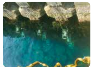
石炭灰重量モルタルと生コンクリートを対象とした平板試料を海中に暴露。3種類の異なる試料（生コンクリート、石炭灰重量モルタル、石炭灰重量モルタルの表面を粗くしたものを）、それぞれ3個ずつ異なる水深帯に設置。
