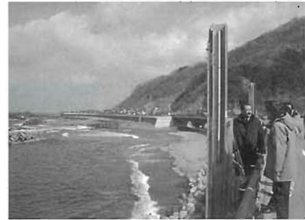
越波測定装置（ステップ式水位計）
