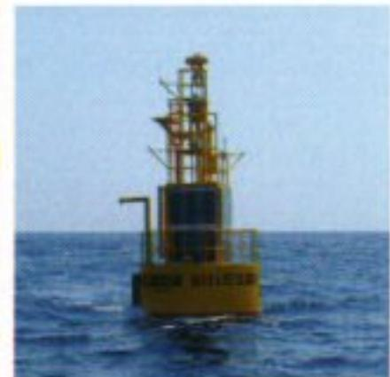
写真2：室戸沖に設置されたGPS津波計
