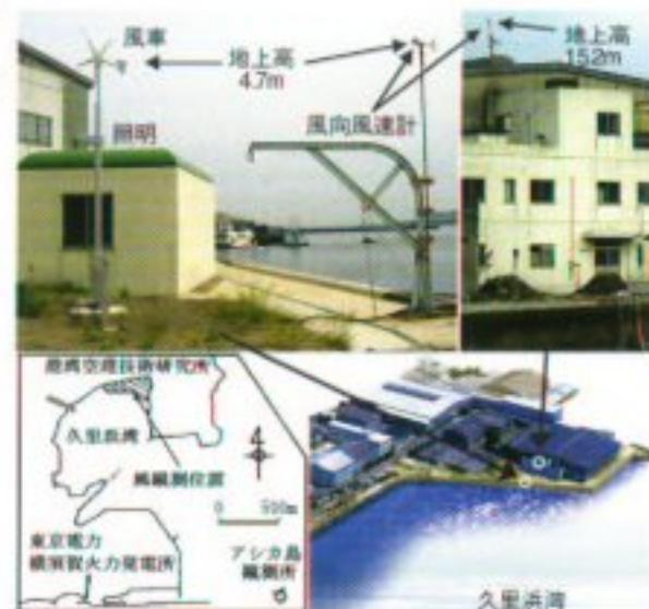
洋上のアシカ島観測所（地盤上13.5m）、実験棟屋上（地盤上15.2m）、および照明柱近傍護岸（地盤上4.7m）の3観測点で風を観測し、局所的な風況変動特性を把握しつつ、風車による発電量と蓄電量に対応するバッテリー電圧とを、常に観測記録して、基本となるデータの蓄積を図っています。
