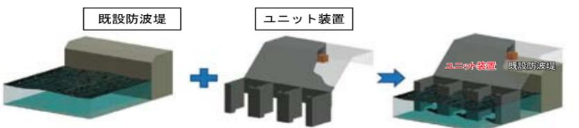
既設防波堤を利用した波力発電システム
