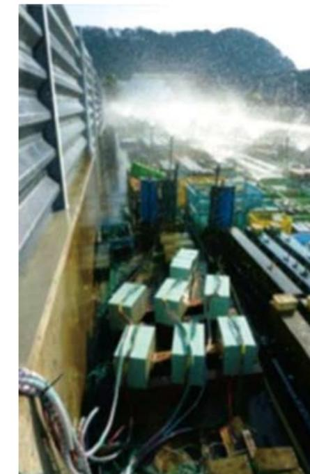
海水シャワー曝露場でのコンクリート試験体の曝露状況(非破壊試験技術を活用した鉄筋腐食推定手法の検討)
