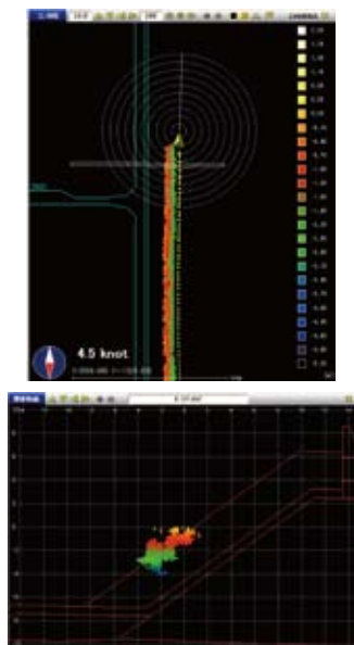
濁水中における映像取得及び測量支援装置の改良 (2010.11.29) 上: CAD 図面上に取得データをオーバーレイ、下: 任意の断面上で計測データを表示
