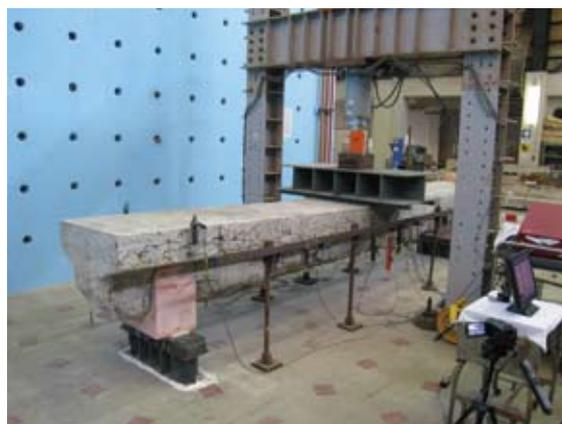
長期供用した栈橋上部工の構造性能評価
