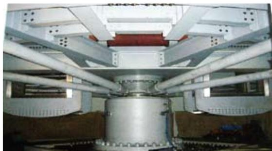
有効半径 : 3.5m (中心から振動台テーブル面までの距離)
