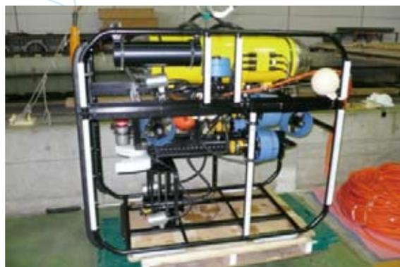
GPS 波浪計係留装置点検システム
