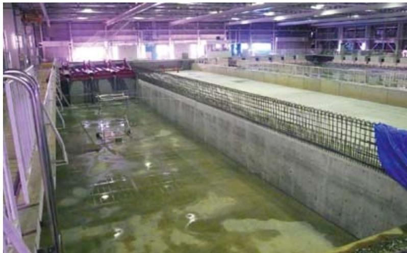
総合沿岸防災実験施設（大規模水理模型実験水槽）
