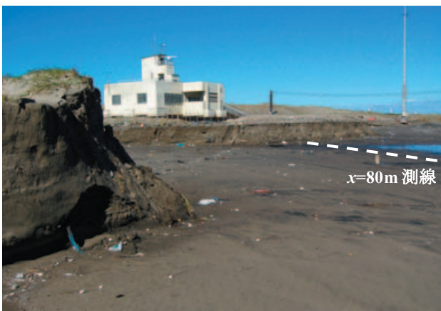
写真-8 浜崖の状況 (x=110m付近, 10月8日, 9時頃)
