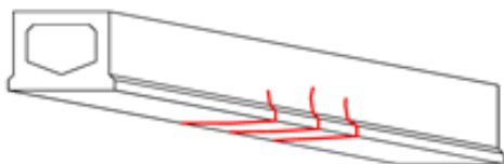
図-2.3 曲げひび割れ
