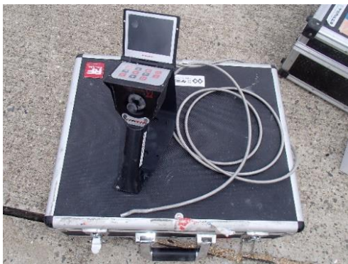
図-10.1.10 ファイバースコープおよび削孔による直接目視状況
