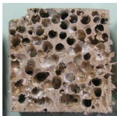
図-3 フナクイムシ食害を受けたブナ 4cm 角材の切断面（海水浸漬6か月）
