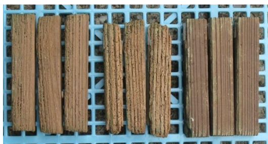
図-19 窒素雰囲気下での熱処理材（海水浸漬10年） 左から、200℃36h, 220℃24h, 220℃36h各3個
