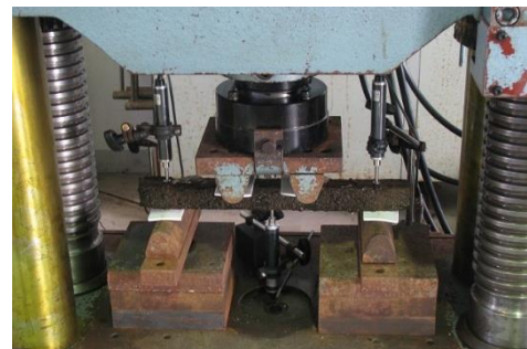
図-9 被覆木材試験体の曲げ荷重状況
