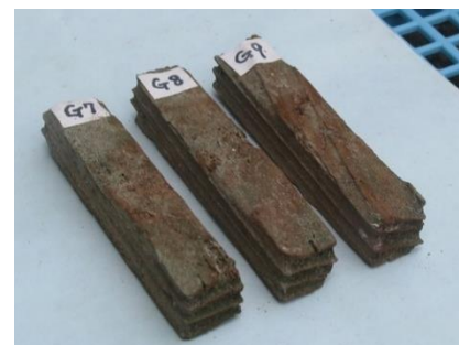
図-17 水蒸気雰囲気下での熱処理材（237.5℃5h）海水浸漬 13 年後の試験体 No. 7～9
