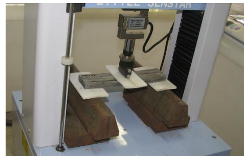
図-8 100 樹種試験体の曲げ荷重状況
