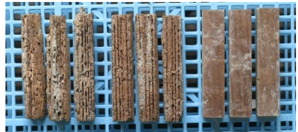
図-15 水蒸気雰囲気下での熱処理材（海水浸漬 3 年）左から，220℃2.5h，230℃3h，237.5℃5h 各 3 個
