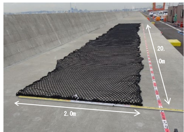
写真-B.8 ネットバッファの全体寸法
