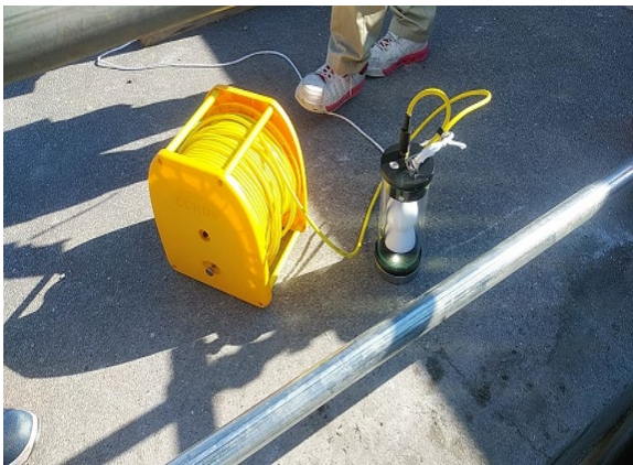
写真-A.9 水中カメラ（清掃確認用）
