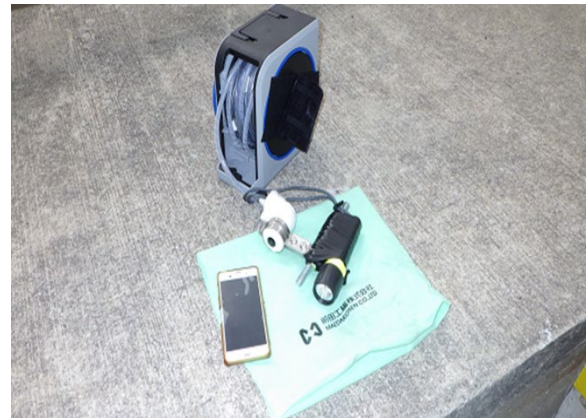
写真-A.19 水中カメラ2 (出来形確認用)
