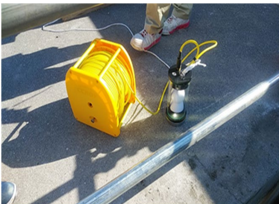
写真-A.18 水中カメラ (出来形確認用)
