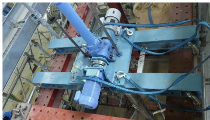
写真-2 貫入・鉛直载荷装置（上から見た様子）
