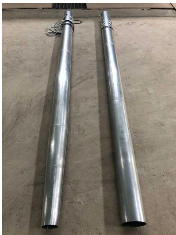
写真-1 肉厚 2mm のストレート杭とテーパ杭
