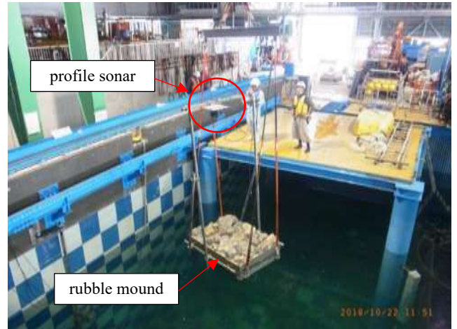
図-3.48 水槽実験状況
