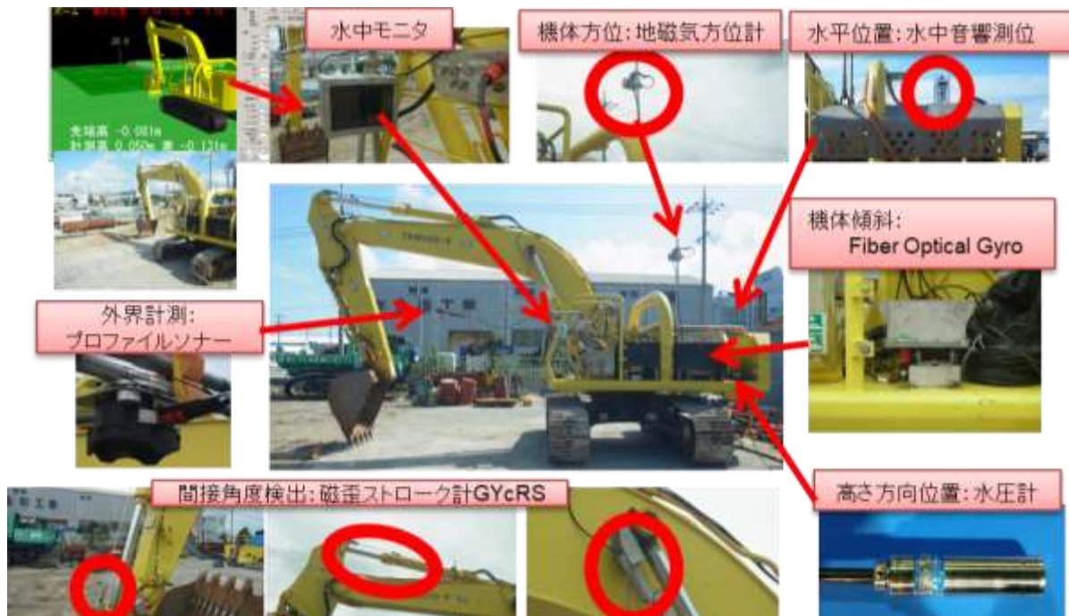
図-5.2 水中バックホウ（TKM200-9）、および、センサ配置図
