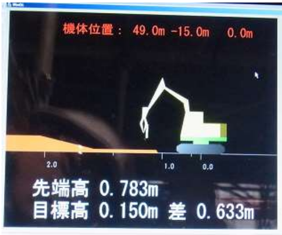
図-4.19 対象物の正面断面の表示
