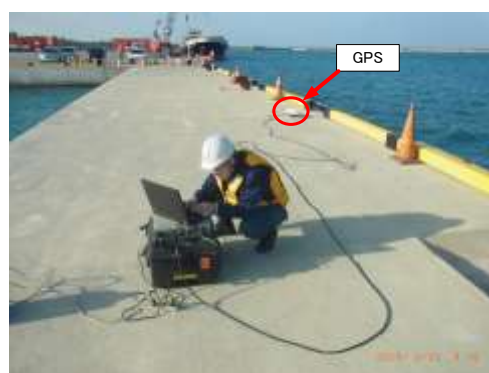
図-5.7 MG 原点座標計測（既設防波堤）
