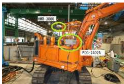
図-4.2 傾斜センサの設置位置
