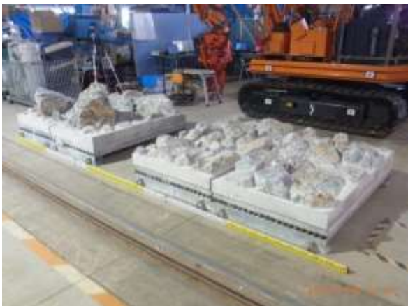
図-3.46 マウンド模型 (左: 模型 2 (不陸: -10 ~ +50cm), 右: 模型 1 (不陸: ±10cm))
