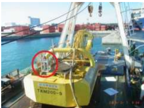
図-5.12 SBL（トランスポンダ）設置状況
