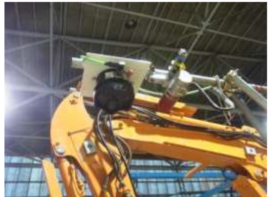
図-3.55 プロファイルソナー設置状況
