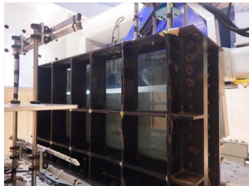
f) 遠心場での自重圧密（遠心载荷実験装置上の様子）
