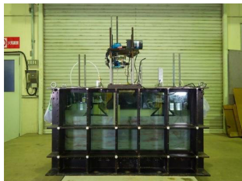
h) 堤体模型や各種装置を設置した模型地盤
