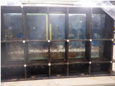
c) ガラス面にローズクレーの塗布
