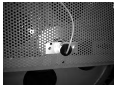
写真-3.2 光学式エンコーダ (COPAL 電子 RE30E)
