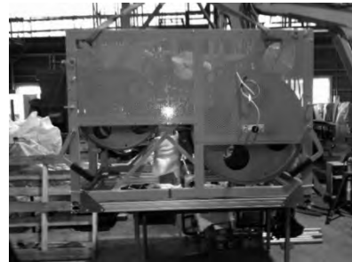
写真-3.1 台枠のウインチへの設置状況
