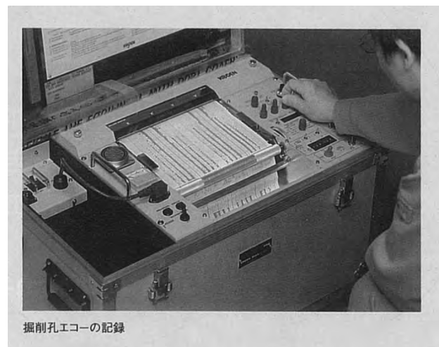
図-2.2 掘削孔エコーの記録の様子 出典 光電製作所カタログ
