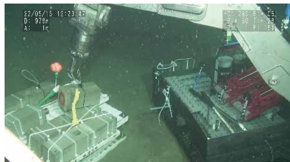
深海(約3515m)における部材接合実験
