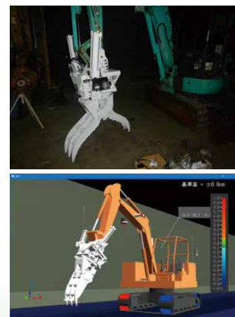
開発したチルトフォークグラブ(上)、遠隔操作システム(下)
