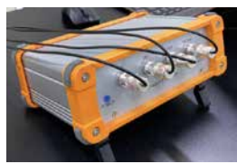
図1 本手法を搭載した腐食診断機
