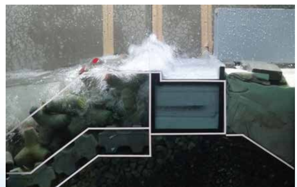
ダブルパラペット型の護岸の実験
