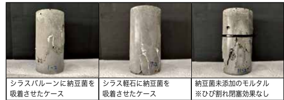
ひび割れを導入したモルタル試験体の自己治癒効果の確認
