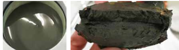
電気浸透圧密脱水試験前後の東京湾粘土供試体
