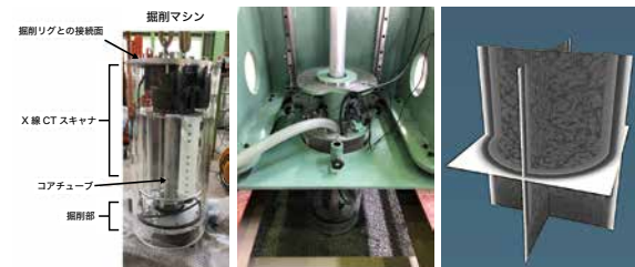
X線CTスキャナ内蔵型掘削装置と掘削実験 掘削後地中で撮影したCT画像
