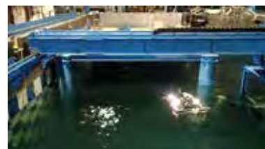
栈橋上部工点検用ROVと水槽実験状況(波浪、流れ条件)
