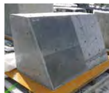
高密度リサイクル骨材(銅スラグ細骨材)を用いたコンクリートの施工実験 (実機プラントで製造したポンプ圧送で打設)
