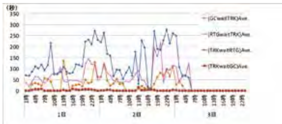
荷役機械相互の待ち時間の図。RTGとトラック(TRK)が互いに待ち合っていることがわかる。(CONPAS、オンドック、遠隔RTG使用、150万TEU/年のある週のデータ想定)
