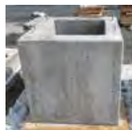
高密度リサイクル骨材(銅スラグ細骨材)を用いたコンクリートの施工実験 (実機プラントで製造したポンプ圧送で打設)
