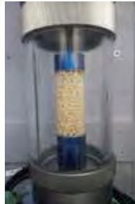
同じ粒子構造をもつ疑似供試体の圧縮試験
