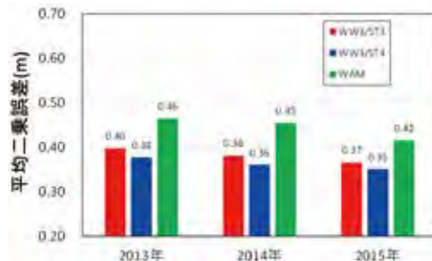
WAM及びWW3による推算精度の比較例(波高、全25地点の平均)
