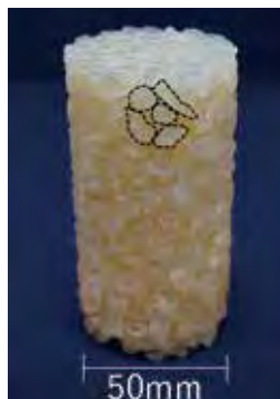
礫材を3Dプリントした擬似供試体
