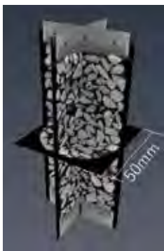
礫を用いた三軸供試体のCT画像例
