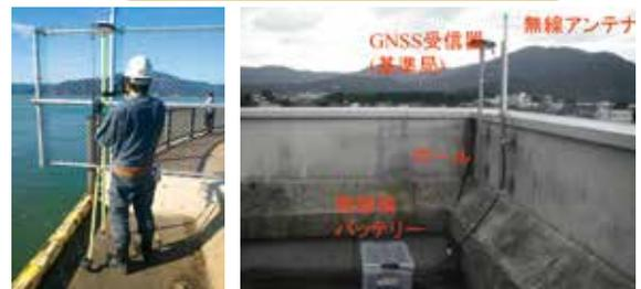
RTK-GNSSを用いた岸壁変形量計測ツールと敦賀港における試測
