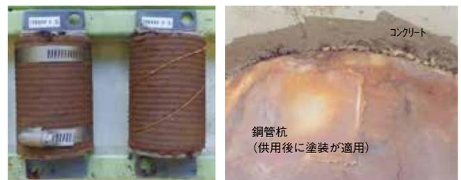
ペトラタム防食材の性能評価手法の確立のための劣化促進試験 (鋼管に防食材を巻き、60℃水道水中で回転) 供用後に塗装工法が適用された既設鋼管杭とコンクリート上部工の境界部 (境界部で腐食が進行)
