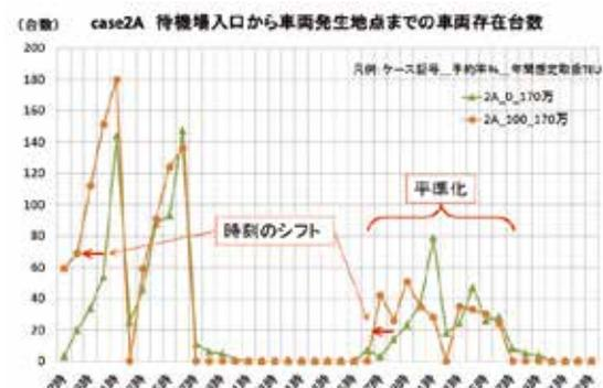
シミュレーションの例。Case2Aは、比較的ゲートを1か所に集中させた度合いが強い例。予約なしの緑色のグラフに対して100%予約制となった場合のオレンジ色のグラフは、早い時刻から渋滞するが、車両数が比較的少ない日(右側)では平準化する効果がある。なお、渋滞の原因は埠頭内の道路経路の容量不足が大きく影響していると考えられる。
