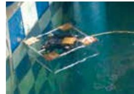
水中ロボットのコンクリート壁面への衝突実験の様子
